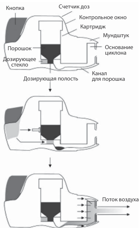
Рис. 1. Схематическое изображение действия устройства Novolizer®
